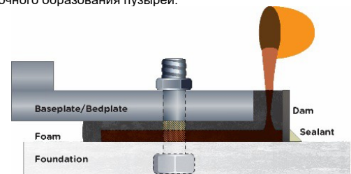
Рисунок 5. Подливка Belzona 7111 тонкой струей
